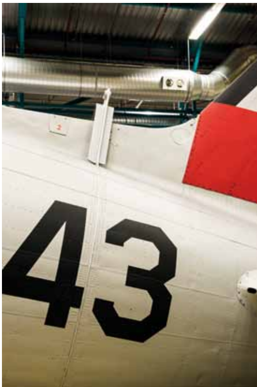
Afb. 6 Resultaat van de werkzaamheden aan de Dakota. De ronde plaat loopt tussen de 3 en de 4 door. Netto resultaat is dat de lengte van het vliegtuig van 19,63 meter met ruim een centimeter is toegenomen, en de spanwijdte van 28,90 meter met twee keer een centimeter.
