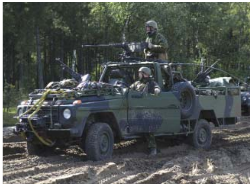
Afb. 7 Uit het huidige MB bestand is een MB ziekenauto gemodificeerd voor het KCT. De ziekenbak is eraf gehaald en er is een nieuwe lage bak op geplaatst. Er is wel meer ruimte ontstaan, onder andere voor een extra MAG achterop, maar de terreinvaardigheid is niet optimaal door de lange overstekende bak. Het motorvermogen is nog steeds hetzelfde en dus onvoldoende.
