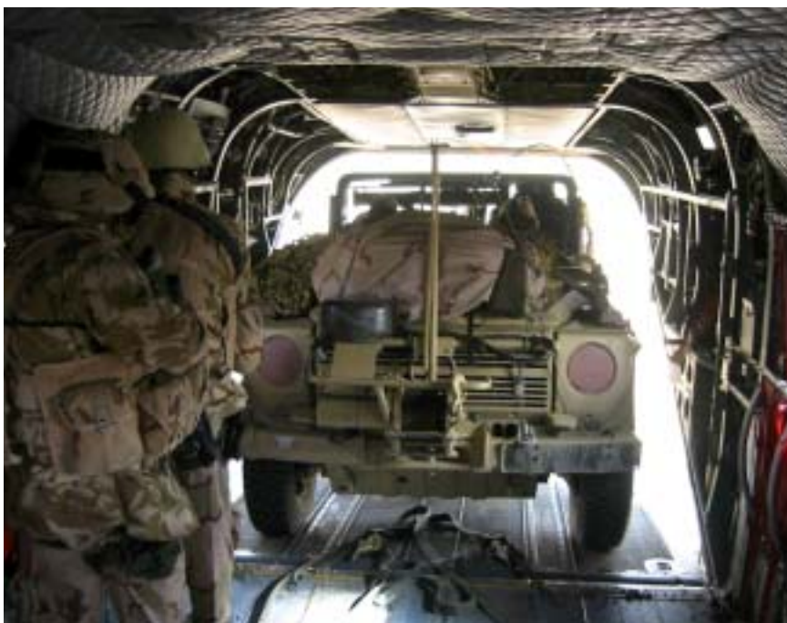
Afb. 4 Passen en meten met een MB in een Chinook helikopter in Irak. Deze heeft nog een oud type draadsnijder en de oorspronkelijke rolbeugel. De ringaffuit is hier nog niet op gemonteerd. Let op de Britse smockjassen, deze verstrekten het KCT aan de ploegen die naar Irak gingen (zie ook afb. 3). (Foto Korps Commandotroepen)
